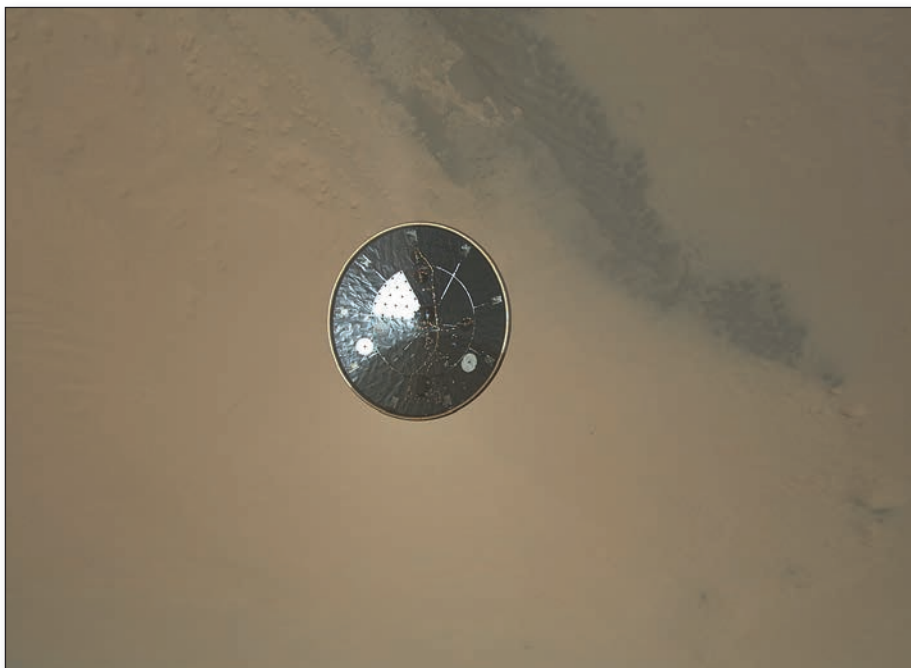
Обтекатель диаметром 4,5 м, отделившийся от посадочной ступени Curiosity во время прохождения марсианской атмосферы за 2,5 минуты до посадки.
