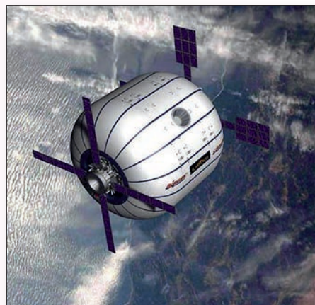
Прототип надувного модуля BEAM (Bigelow Expandable Activity Module), разработанного компанией Bigelow Aerospace, будет испытан в ближайшее время в составе МКС.
